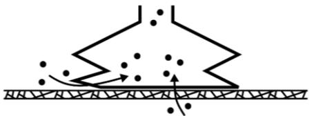
Las fugas en piezas pueden ser aún más difíciles de identificar. Las cosas que parecen completamente herméticas pueden no serlo en absoluto. Un ejemplo típico son las cajas de cartón grueso. La delgada capa exterior a menudo requiere mucho caudal de aire para crear una diferencia de presión sobre ella (consulte la siguiente figura).
