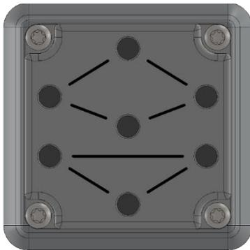
La placa adaptadora tiene 7 orificios para utilizar conectores con ventosas o tornillos ciegos en función de sus necesidades. También tiene líneas que muestran los orificios que están comunicados. Esto resulta útil cuando se utilizan los canales A y B independientemente para el vacío.
